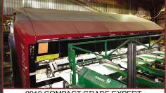
2019 COMPACT GRADE EXPERT OPTIMIZER 7500B AUTO GRADING SCANNER
