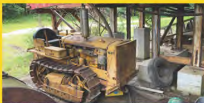
Cat D2 Dozer
