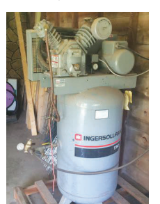
Ingersollrand 80 gal air compressor.
